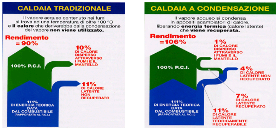
Fig. III.2 – Diagramma di Sankey per una caldaia tradizionale e per una a condensazione
